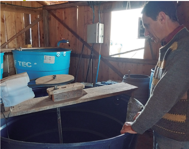
Aérateur à moteur de machine à laver, installé dans une cuve d'eau, pour la reproduction de communautés microbiennes, sur le site de Marcos Mosquer, 2025.
