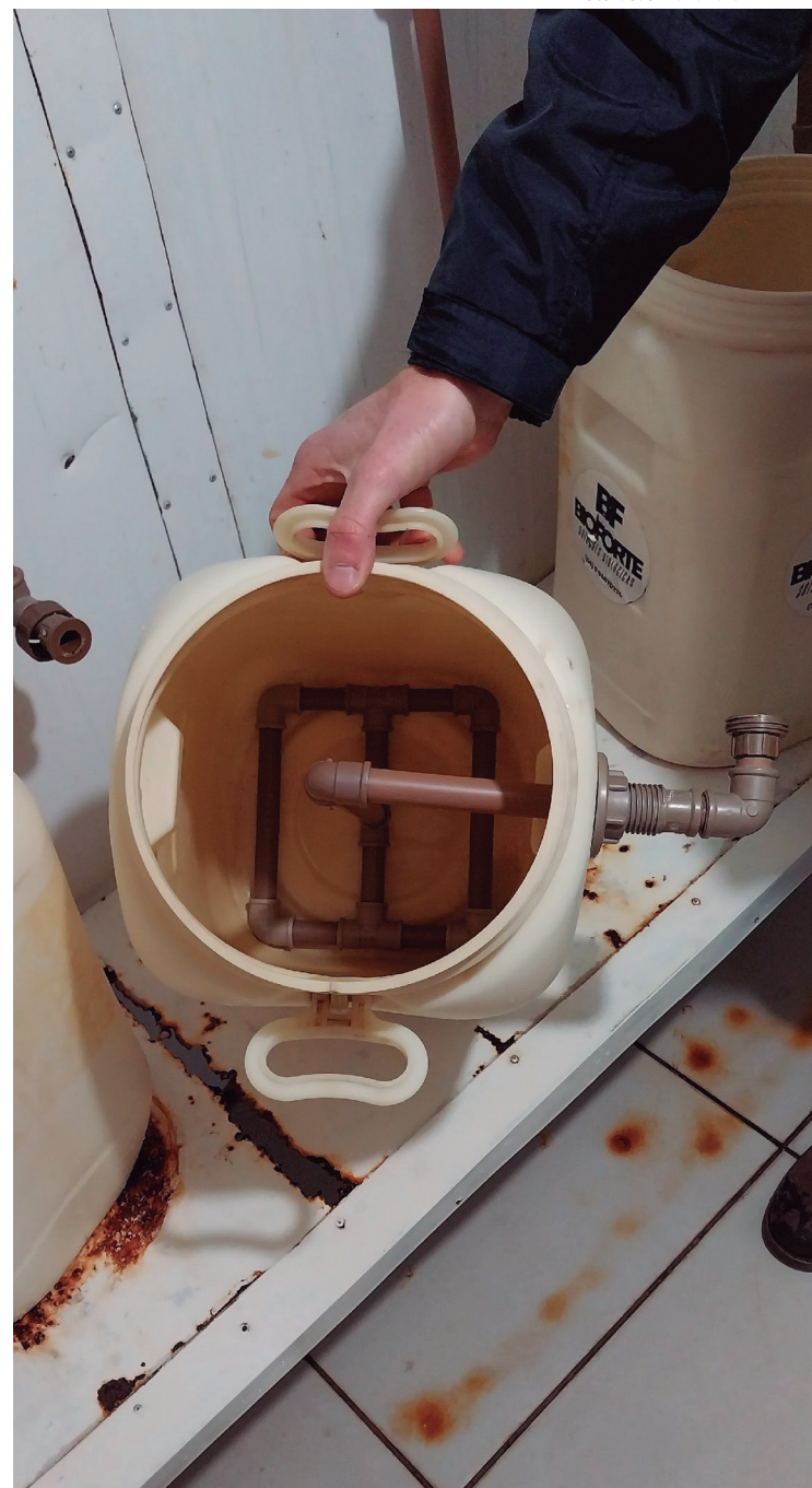
Bioréacteur avec aérateur au fond. Groupe Mains sur Terre 5 , 2025
