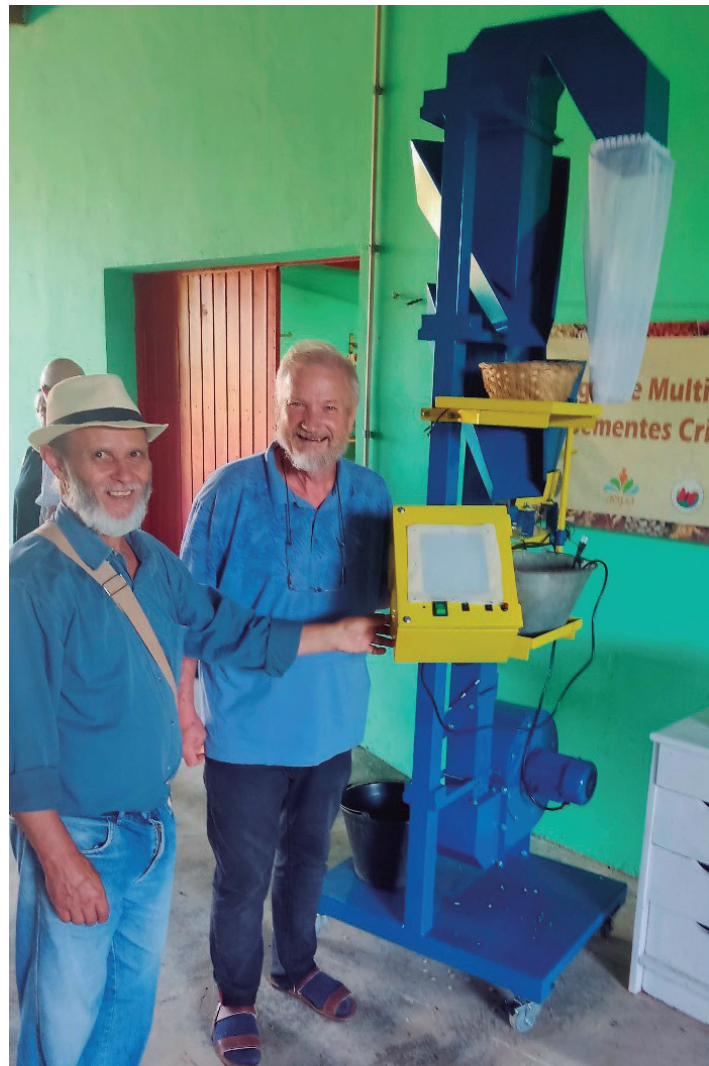
Machine de nettoyage de semences. Maison des semences, 2025
