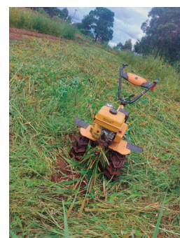
Agricultor y técnico, trabajando con un motocultor con ruedas de hierro. Alex S. Souza, 2024
