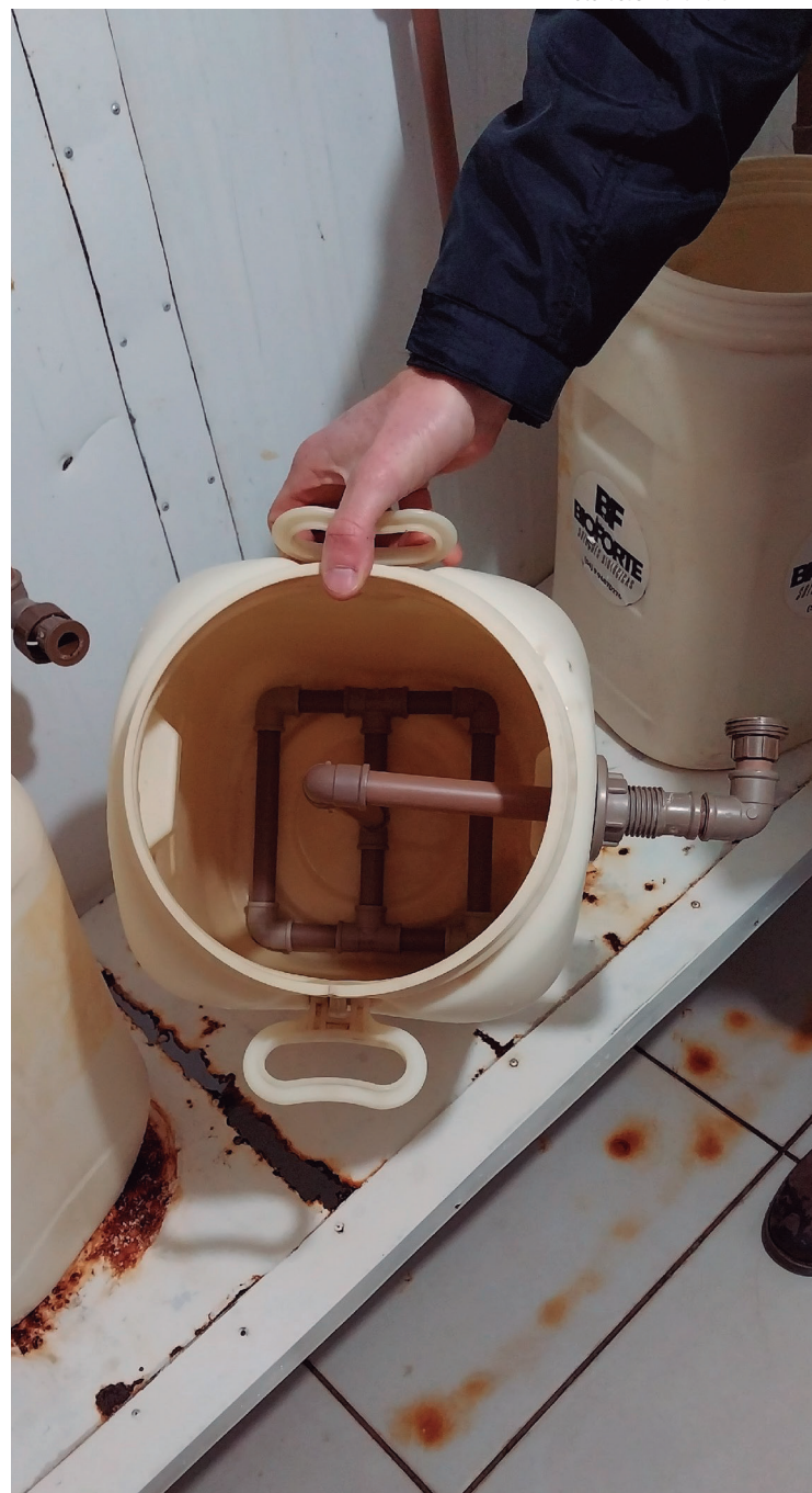
Biorreactor con aireador en la parte inferior. Grupo Manos a la Tierra 5 , 202
