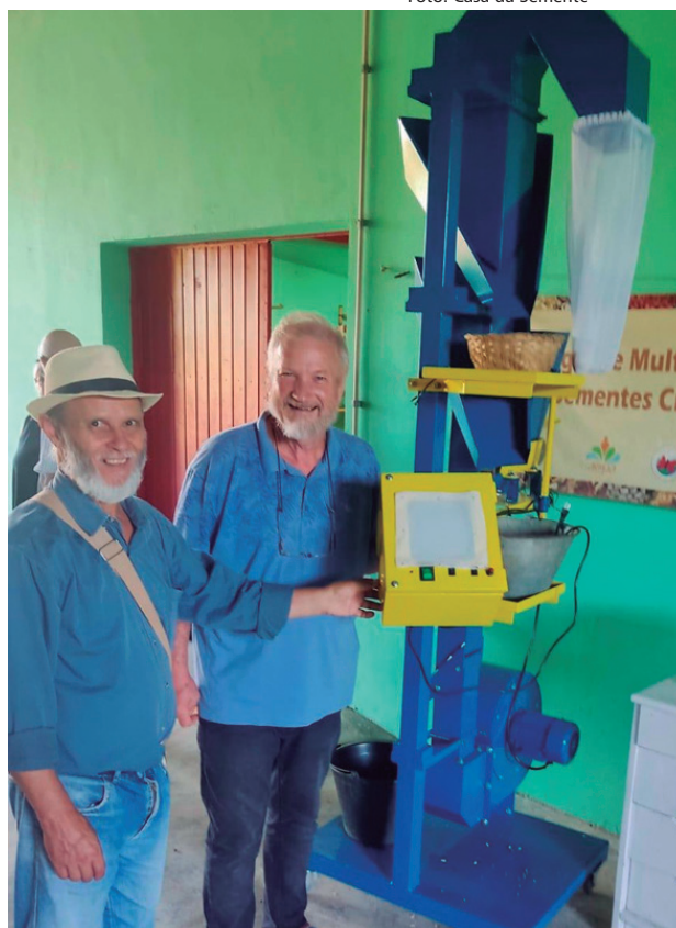
João Batista Dantas, trabalhador integrante da equipe e o técnico Hans apresentam a máquina de coluna de ventilação para a limpeza e classificação das sementes de hortaliças, com adequações mecânicas desenvolvidas localmente, 2025
