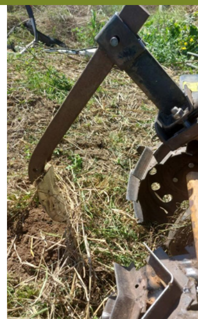
Motocultivador com rodas de ferro, com o qual se fez o acamamento das plantas de cobertura do solo (esquerda) e Pé de Pato acoplado ao motocultivador, utilizado para se abrir as linhas de plantio das hortaliças, 2025
