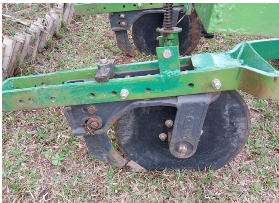
Detalhe do sulcador e disco de corte devidamente posicionados, 2025
