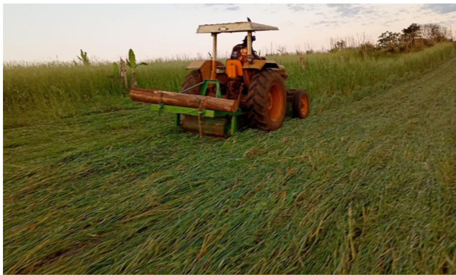
Neomar fazendo o acamamento de plantas de cobertura com o rolo-faca NCL para plantio em SPDH. Ele utiliza um tronco sobre o rolo-faca para aumentar seu peso e, assim, proporcionar melhor acamamento, 2025
