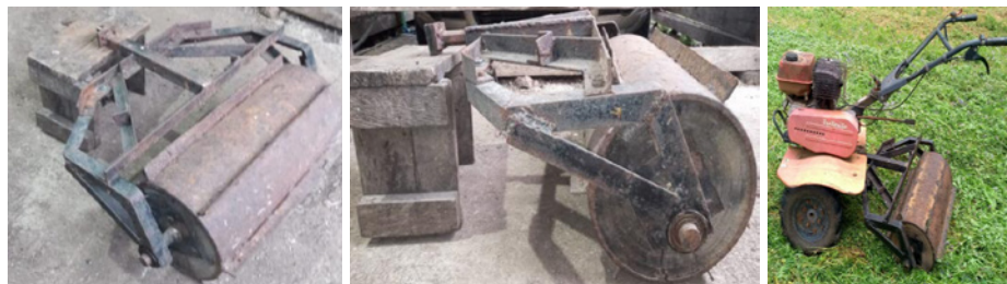
Rolo-faca fabricado localmente, com excelente capacidade de acamamento das plantas de cobertura de solo, adequado para motocultivador de pelo menos 6,5 cv. 2025
