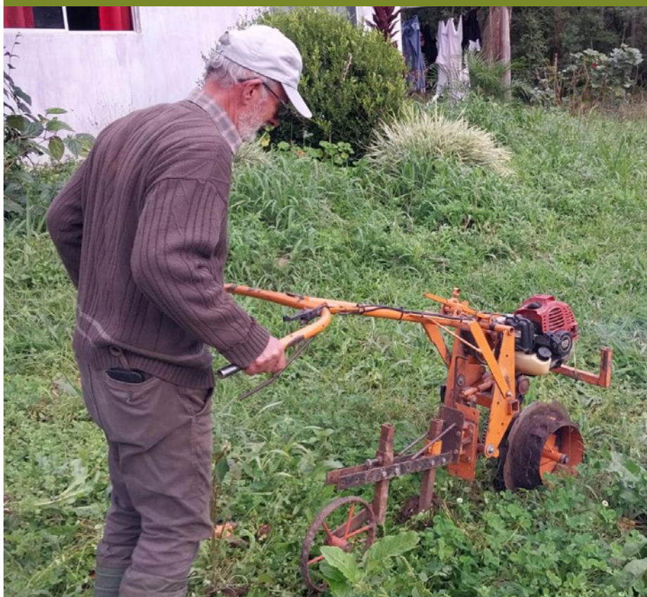
Aires com o monotrator utilizado nos testes, sendo a roda da frente um disco para corte da fitomassa e atrás o conjunto para abertura do sulco de plantio, 2025
