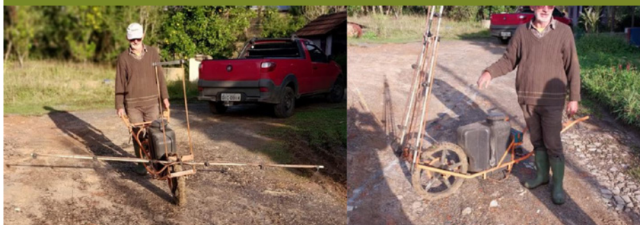
Aires com o pulverizador (para caldas e biofertilizantes) acionado por roda de bicicleta, 2025
