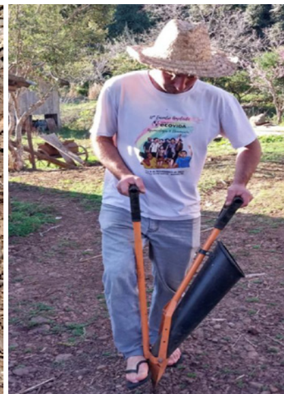
Bico da plantadeira pica-pau da Knapik, que Roberto sugere reforçar (esquerda), 2025. e Roberto simula um estribo na plantadeira para servir de apoio ao pé (direita), 2025
