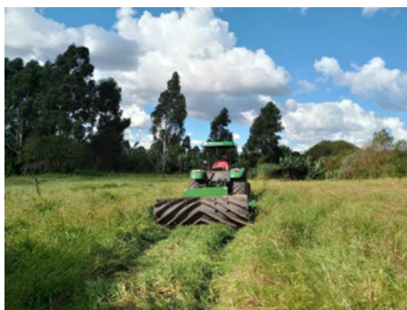
Rolo-faca helicoidal, de grande porte (esquerda) e rolo-faca de hastes retas, de pequeno porte (direita), 2024
