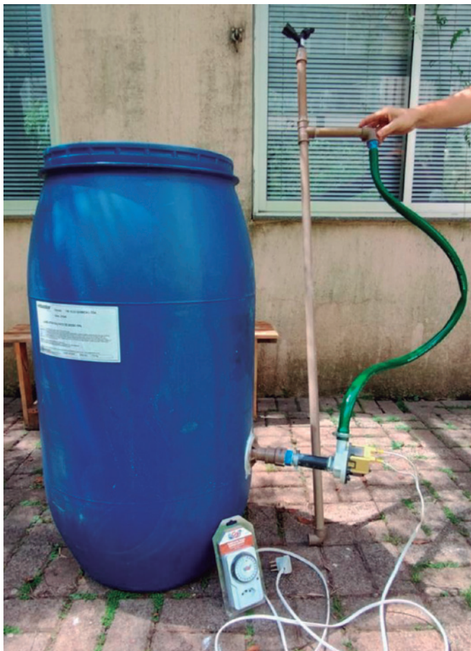
Bombona adaptada para produção de biofertilizante aeróbico, modelo Epagri, 2024
