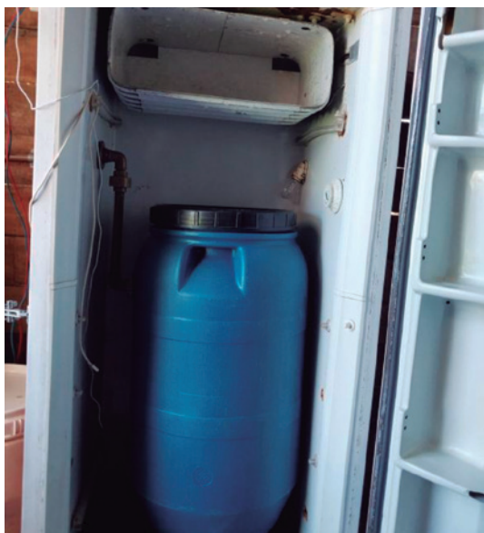
Biorreator adaptado no interior de uma geladeira usada, onde se controla a temperatura, 2025
