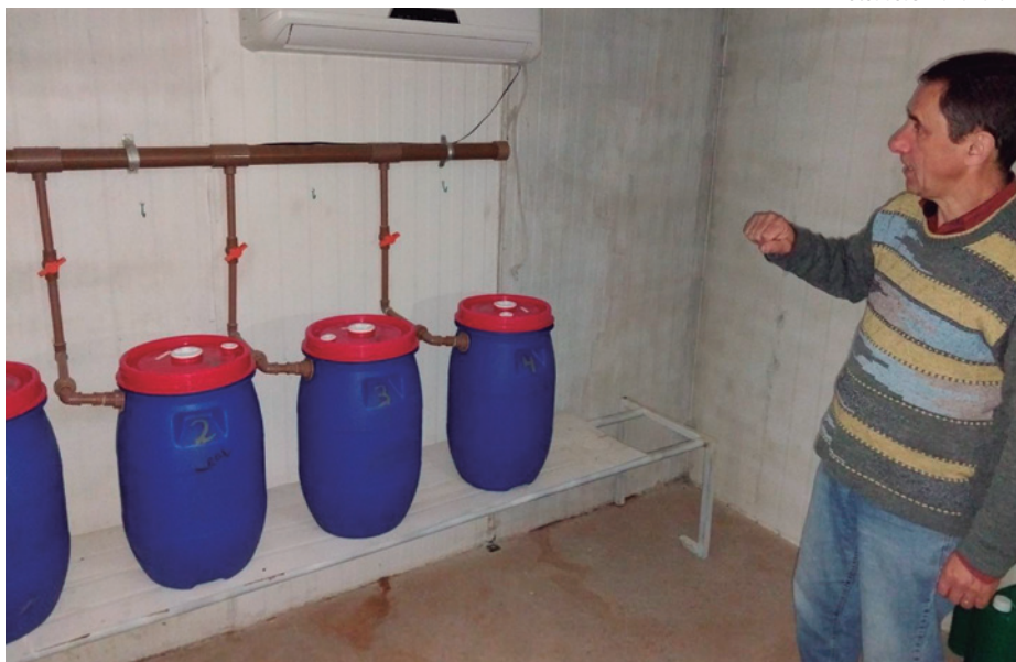
Marcos Luciano Mosquer, no interior da biofábrica, com quatro biorreatores, onde multiplica microrganismos isolados, 2025
